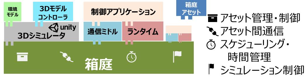
シミュレーションに必要な、"3Dモデル"、"制御プログラム"、"ミドルウェア"、 "ランタイム"、シミュレータ"などはすべて個々のアセットとして部品化し、任意の 組み合わせに差し換え可能!
