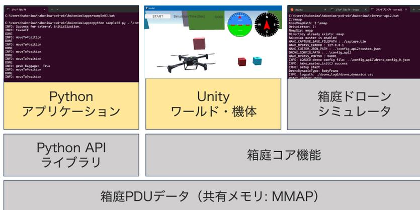
図1. 箱庭ドローンシミュレータの構成
